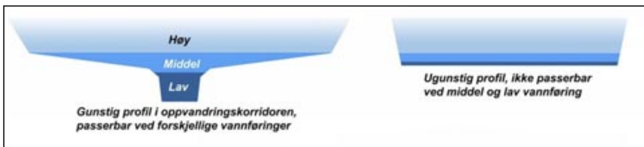
Fig. 26 Prinsippskisse av tverrprofil: Det anbefales en V-formet profil med dypål (lavvannsrenne) som sikrer vandringsmuligheter ved varierende vannføringer.
