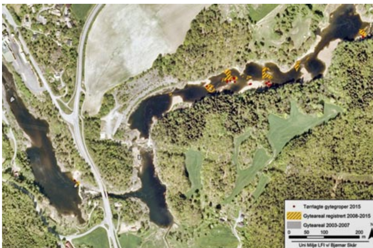
Fig. 88 Oversikt over registrerte gytegroper i restfeltstrekningen mellom Rykene og Helle i Nidelva i perioden 2003–2015. De grå områdene er fra før tersklene ble revet, mens oransje områder er i perioden etter. De oransje områdene er nye gyteområder som er blitt tilgjengelig etter at gytefisker og vannstrømmen har bearbeidet og løsnet opp gytegrusen. Denne gytegrusen var kittet fast i elvebunnen på grunn av lav vannhastighet, som følge av at disse tidligere lå i terskelbassengene. I 2015 ble det registrert noen tørrelagte gytegroper vist som røde punkter.
