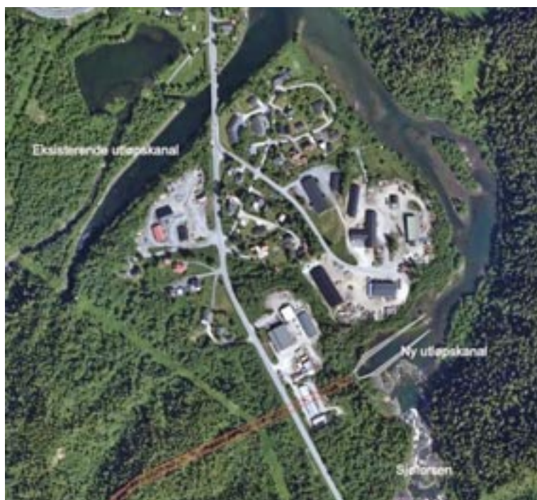
Fig. 132 Utgangspunkt for elverestaureringen; a) i forbindelse med rehabiliteringsplaner for det 60 år gamle Nedre Røssåga kraftverk ble det besluttet å bygge nytt kraftverk, der utløpet ville bli flyttet øverst i tidligere anadrom del av elva. b) og c) Det tidligere tørrlagte elveløpet ville se slik ut ved maksimal driftsvannføring (105 m 3 /s) i det nye kraftverket
