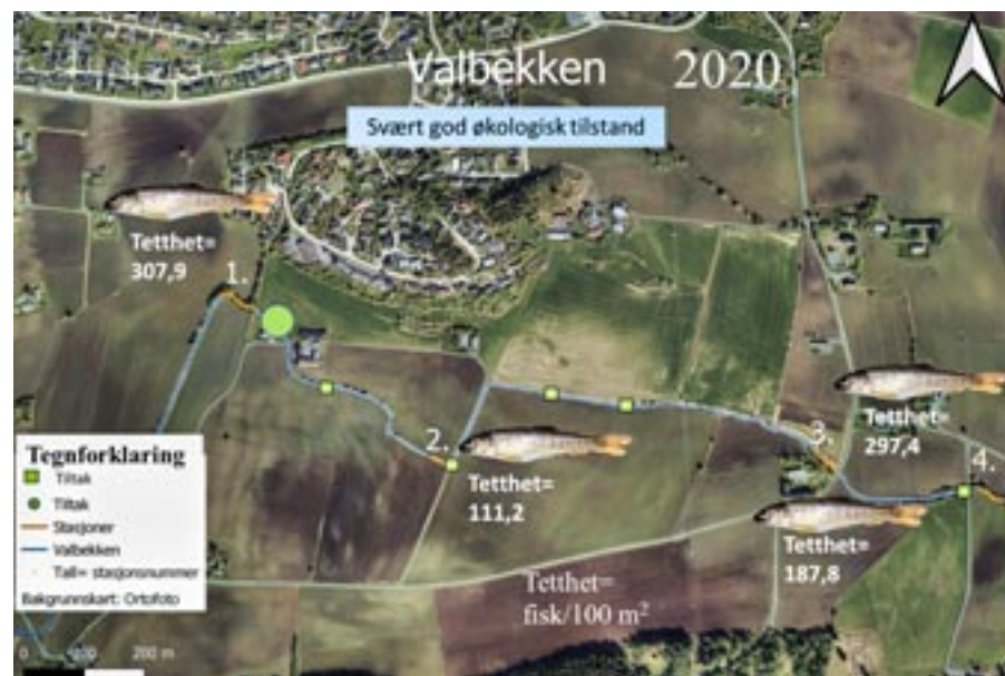
Fig. 154. Situasjonen i Valbekken før (2017) og etter (2020) montering av løsterskler i fiskesperrende kulvert (pkt 1) august 2019. Tettheter gått fra null til 111-297 fisk/ 100 m 2 i elfiskestasjonene 2-4 etter første gyting. I stasjon 1 nedenfor tidligere sperre en økning fra 64 til 308 individer/100 m 2 . Bilder: Emilie Pedersen
