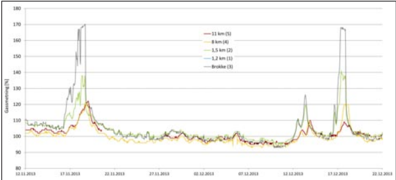
Fig. 72 Typisk gassmetningsforløp i Otra nedefor Brokke kraftverk om høsten. Gassovermetningsbølger fra Brokke og nedover i Otra til Tjurrmo-dammen (11 km). Overmetningen er forårsaket av nedbørshendelser med påfølgende høy vannføring og luftinndrag i bekkeinntak.
