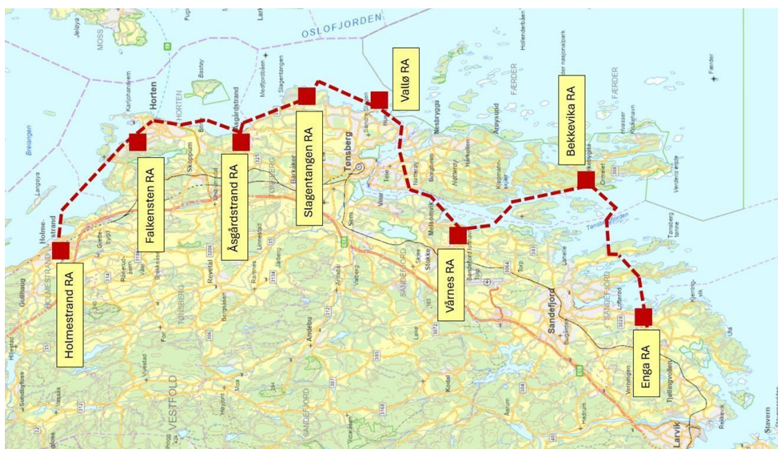
Bilde 7. Kartet viser aktuelle plasseringer av renseanlegg og mulige traséer for ledninger. Bakgrunnskart: Norgeskart. Nytt nitrogenrenseanlegg - Tønsberg kommune (tonsberg.kommune.no)
