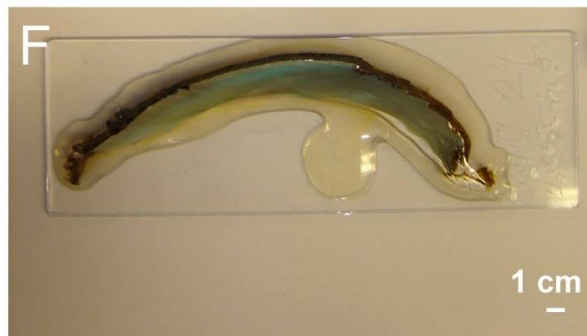
Figur 1.3. A- Musselskalen sågades vinkelrätt mot vinterlinjerna från den ventrala kanten till den yngsta, umbonala, delen med hjälp av en diamantklinga; B- Polering av skalsnittet; C- klistrades fast på objektglas; D- Skalen sågades så att ett tunt skalsnitt (ca 0,5 mm) är kvar på objektglaset; E- Etsning med Mutvei's blandning; F- Färdig slipsnitt.
