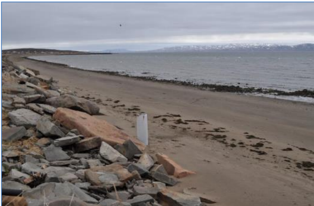
Fig 6.1: Foto viser rør som ble satt inn for å måle sigevann fra Skittenelv deponi i Vadsø. Resultatet av prøvene viste forhøyede verdier av blant annet arsen, krom, kobber, bly og kvikksølv.
