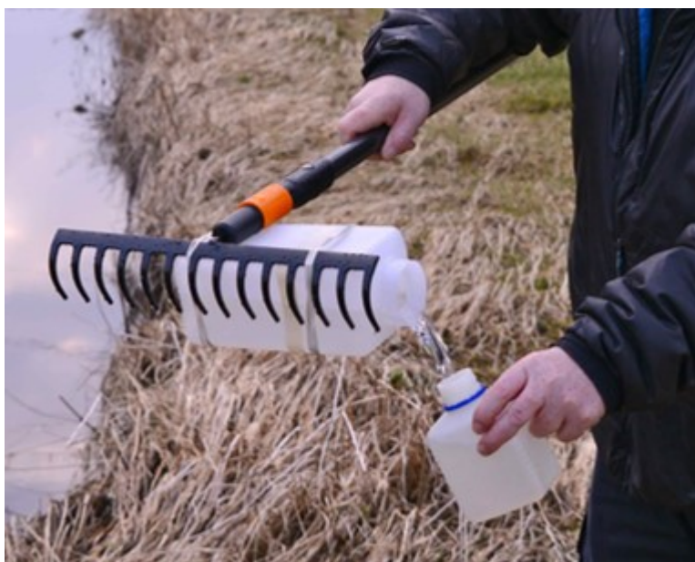
Bilete 19. Vassprøvetaking med godt tilpassa utstyr. Foto: Sveinung Klyve.
